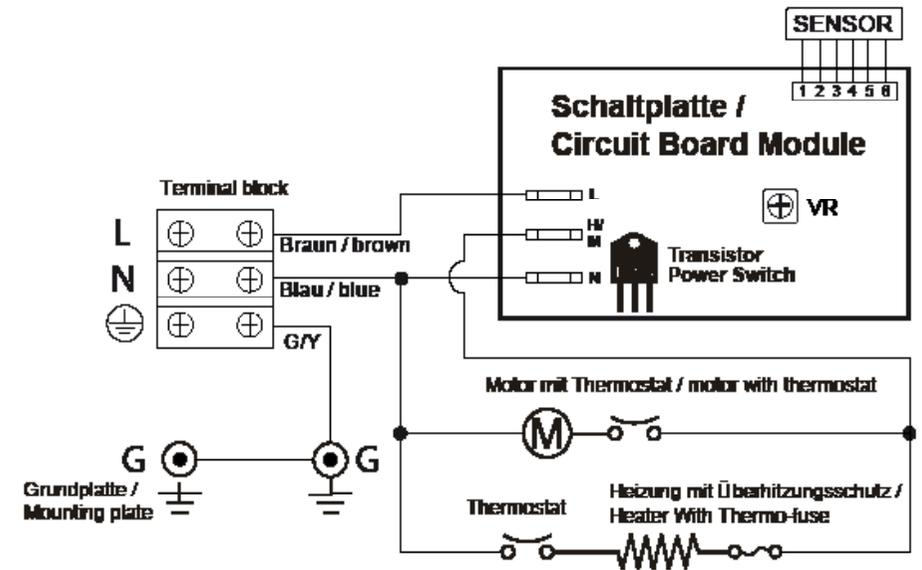
1. Führen Sie das stromgebende Kabel zur Klemmleiste / Connect supply wires to terminal block where indicated.
