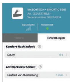
Die **Komfort-Nachlaufzeit** (verzögertes Schließen der Armatur, nachdem die Hände oder der Gegenstand aus dem Erfassungsbereich entfernt werden) kann ebenfalls angepasst werden.
