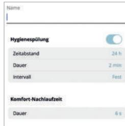
Mit der Funktion „Kopieren- und-Einfügen“ können gewählte Einstellungen in der App gespeichert und auf andere Armaturen übertragen werden. Eine garantierte Zeitersparnis bei der Installation.
